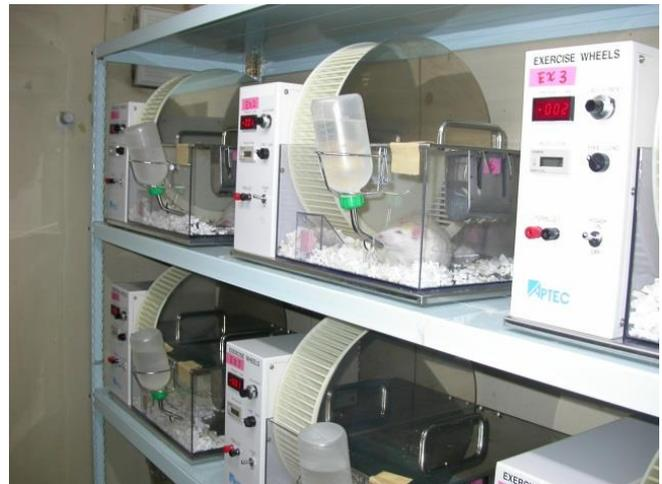
**図 1.** 実験動物用の走運動装置。飼育ケージに回転車輪が附属しており、自由に走運動が行える。磁力により回転車輪に任意の負荷を加えることができる。合計 20 台の回転車輪の走行距離や走速度を同時に記録・保存することができる。
