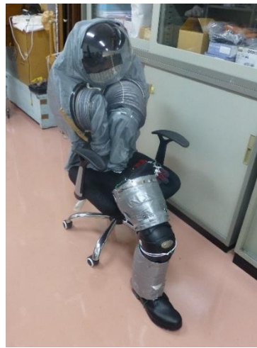
図 4 肩関節にフレーム付きジャバラを採用した高与圧宇宙服モデル
