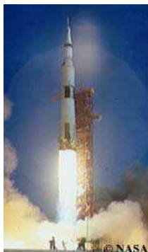
サターンVロケット ・人類が製造した最大のロケット ・直径10m × 全長102m ・打上げ時総重量3038.5トン
