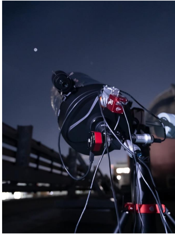
図 2: 衝突閃光の観測に成功した PONCOTS 観測システム。京都大学吉田キャンパス施設屋上に設置して木星のモニタ観測を実施していた。
